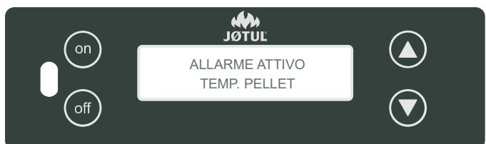
Si verifica quando la temperatura della sonda pellet è troppo elevata. Per ripristinare il normale funzionamento della stufa procedere come segue:
