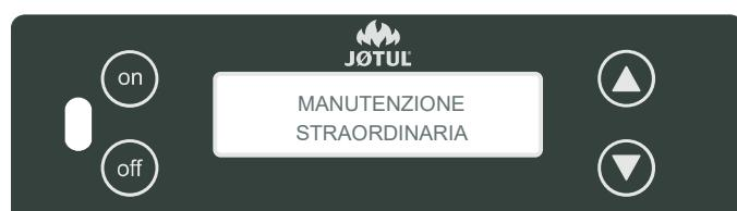
Se sul pannello di controllo compare la scritta **MANUTENZIONE STRAORDINARIA** si dovrà contattare immediatamente il Centro di Assistenza Tecnico per effettuare la manutenzione straordinaria della stufa. Ad ogni accensione verrà emesso un segnale acustico prolungato e il messaggio **MANUTENZIONE STRAORDINARIA** verrà visualizzato ad intermittenza allo stato reale della stufa. Questo fino a quando sarà eseguita la manutenzione straordinaria.
