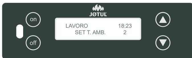
Indica la temperatura impostata dal termostato. Quando la temperatura ambiente sarà uguale a quella impostata, la stufa si regolerà al minimo (potenza 1); per effettuare la regolazione procedere come segue:
