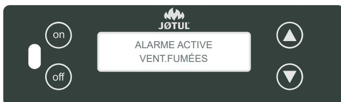
Se déclenche en cas de fonctionnement anormal du ventilateur des fumées.
