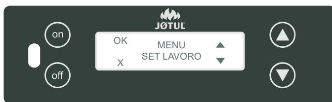
Attraverso questo menù si imposta e si regola il funzionamento della stufa visualizzando contemporaneamente tutti i parametri di lavoro.
