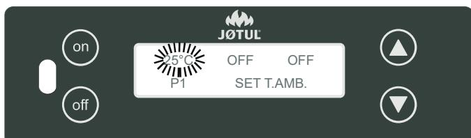
2) Le deuxième paramètre qui clignote me permet de décider à quelle heure le poêle doit s'allumer. Selectionner l'heure souhaitée et appuyer sur "**ON**".
