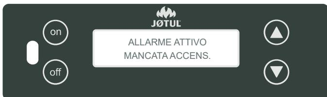
Si verifica alla fine della fase di AVVIO se la temperatura dei fumi non è sufficiente per il corretto funzionamento della stufa. Per ripristinare il normale funzionamento della stufa procedere come segue:
