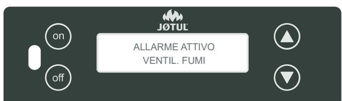
Si attiva quando si verifica un'anomalia nel funzionamento del ventilatore fumi.
