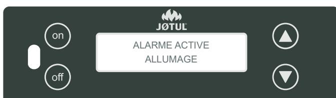
Elle se déclenche à la fin de la phase de MISE EN MARCHE si la température des fumées est insuffisante pour garantir le bon fonctionnement du poêle.
