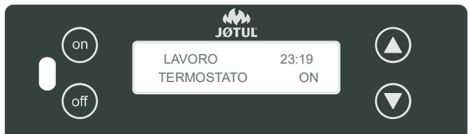
Dopo aver collegato il termostato ambiente quando interverrà, la stufa si porterà alla prima potenza (regime minimo) mantenendo inalterato il funzionamento standard.
