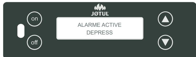
Elle se déclenche en cas d'anomalie de tirage à l'intérieur du conduit de fumée et donc dépression insuffisante.
