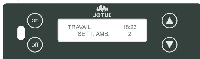
Indique la température établie par le thermostat. Lorsque la température ambiante est égale à la température programmée, le poêle se met à fonctionner au minimum (puissance 1). Pour effectuer le réglage, procéder comme suit : une fois affichée l'indication "SET T. AMB.", appuyer sur la touche pour augmenter la valeur de réglage et sur la touche pour la diminuer.
