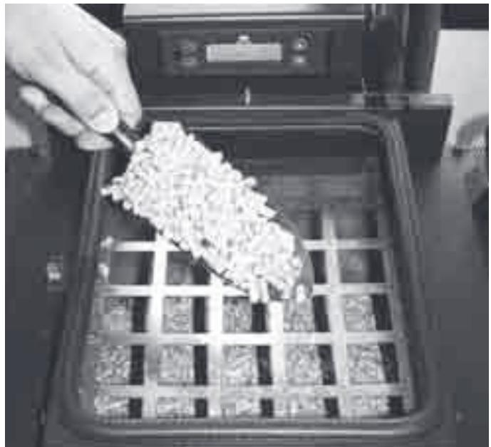
**i** Il pellet deve essere versato nel serbatoio con una paletta. Non svuotare il sacco direttamente nel serbatoio.
