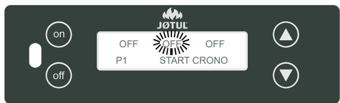
3) Le troisième paramètre qui clignote me permet de décider à quelle heure le poêle doit s'éteindre. Selectionner l'heure souhaitée et appuyer sur "**ON**". "OFF" désactive la fonction d'extinction. Si l'on programme OFF comme horaire d'allumage, on désactive l'allumage. Si l'on programme OFF comme horaire d'extinction, on désactive l'extinction. Cette option est utile lorsque l'on désire programmer uniquement l'allumage ou l'extinction, en excluant l'autre.
