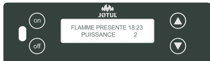
Le poêle passera automatiquement à la phase de fonctionnement si la température est suffisante pour le fonctionnement correct du poêle, sinon se déclenche l'**ALARME ACTIVE ALLUMAGE** (par. 7.7.2). allumage automatique: le poêle est équipé d'un dispositif automatique qui permet d'allumer les pellets sans utiliser d'autre allume-feu traditionnel.
