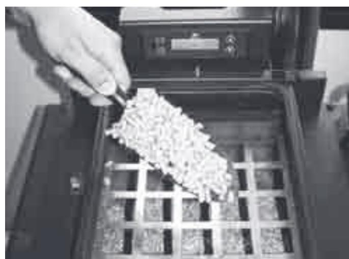
**i** Les pellets doivent être introduits à l'intérieur du réservoir à l'aide d'une palette (voir photo page précédente). Ne pas vider le sac directement dans le réservoir.
