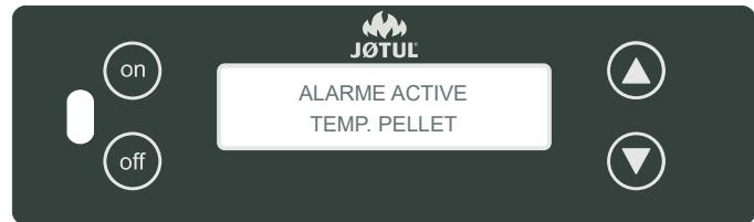
Elle se déclenche lorsque la température de la sonde des pellets est trop élevée. Pour rétablir le fonctionnement normal du poêle
